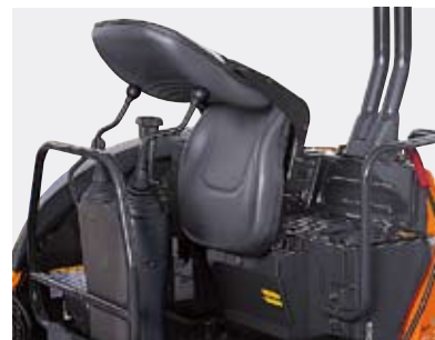
駐機時のシートの汚れを防ぐ 可倒式一体成形シート
