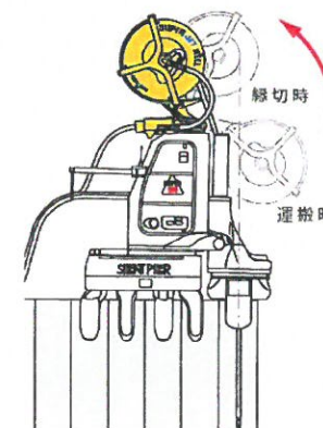
6 鋼矢板を所定の位置まで圧入する。(圧入完了後の周辺地盤は、安定した状態になる。) 7 ジェットリールの巻取り力にてホースを引抜く。 8 ロックピンはホース引抜き力により切断される。
